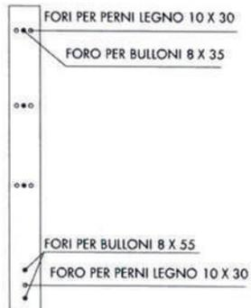
1: METTERE I PERNI LEGNO NEI FORI INFERIORI DEI MONTANTI E, SUCCESSIVAMENTE, INFILARE I MONTANTI SULLA TESTATA ED AVVITARE, NON FINO IN FONDO CON I BULLONI 8 X 55
